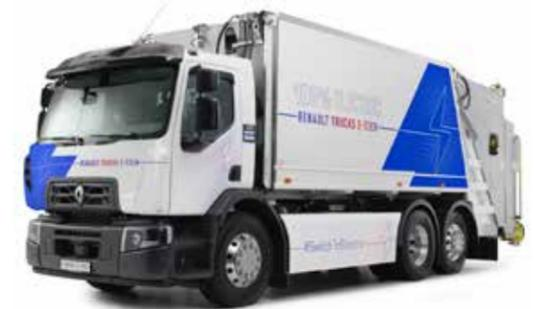
avantage non négligeable, le camion électrique permet de récupérer de l'énergie lors des phases de freinage.
